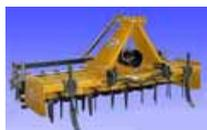
縦軸のナイフプレ - ドが地面に垂直回転して砕土し、コイルローラ - が表層を鎮圧する。
