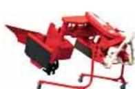
湿田や排水不良田の暗渠埋設用の溝堀り、明渠掘りなどに使用する。
