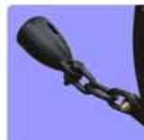
サブソイラに弾丸状のアタッチメントを付けるなどして、モグラの穴状の簡易な暗渠を作る。
